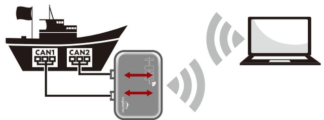
独立した2つのCANポートを持っています。各CANポートは同時に別のCAN通信をモニタリングできます。
