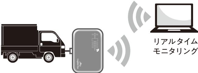
WiFi経由で接続したホストPCから、CAN通信のリアルタイムモニタリングができます。CANフレームのオンデマンド送信も可能です。
